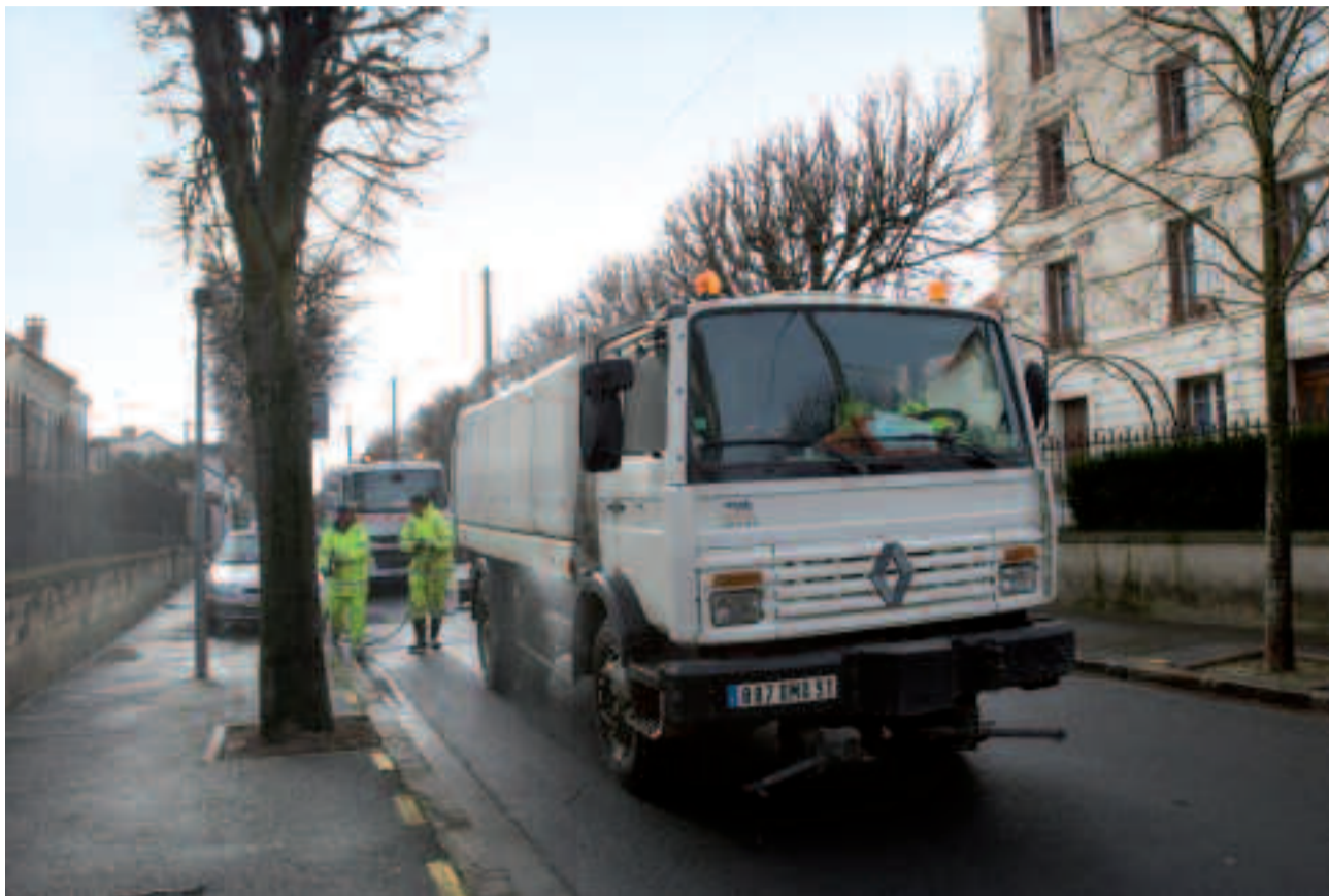
Les engins sont de plus en plus adaptés aux exigences de propreté. Ci-dessus, un train de lavage (laveuse suivie d'une balayeuse) chargé du nettoyage quotidien des rues.
